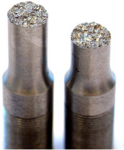
Breukvlak van een gietijzeren proefstuk. Bron: Wikimedia, user Sigmund419
